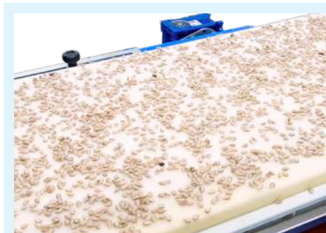
Semis à vibration de grosses graines.
