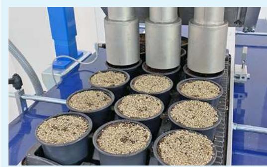
Cobertura localizada con vermiculita.
