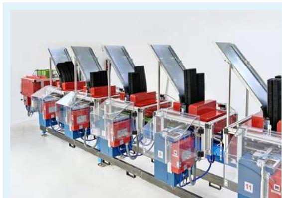
Etichettatrici automatiche EAC montate in serie su nastro con disimpilatori automatici: le etichette vengono applicate alle singole vaschette prima che queste vengano inserite nel contenitore portavaschette.
