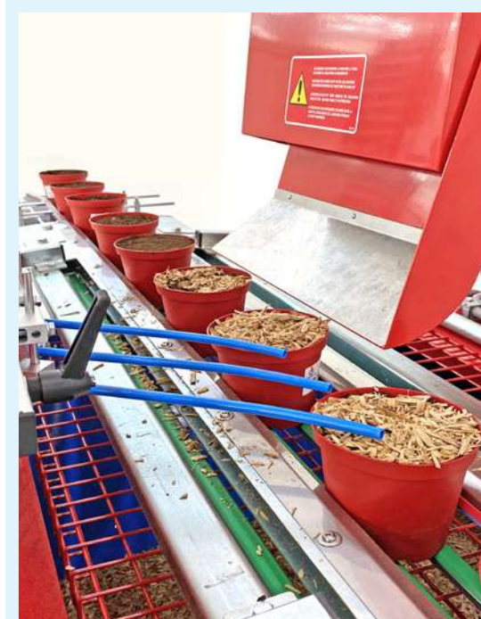
Llenadora IA3500 con cabezal individual : es capaz de trabajar con macetas de 8 a 27 cm , de diferentes formas y materiales.
