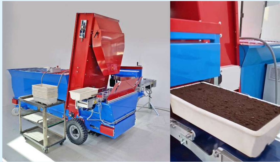
IM2800 équipé pour le remplissage de barquettes.
