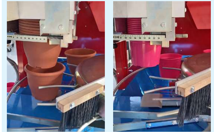
Rempoteuse IA3500 à tête simple, en mesure de fonctionner avec des pots de 8 à 27 cm, de différentes formes et matériaux
