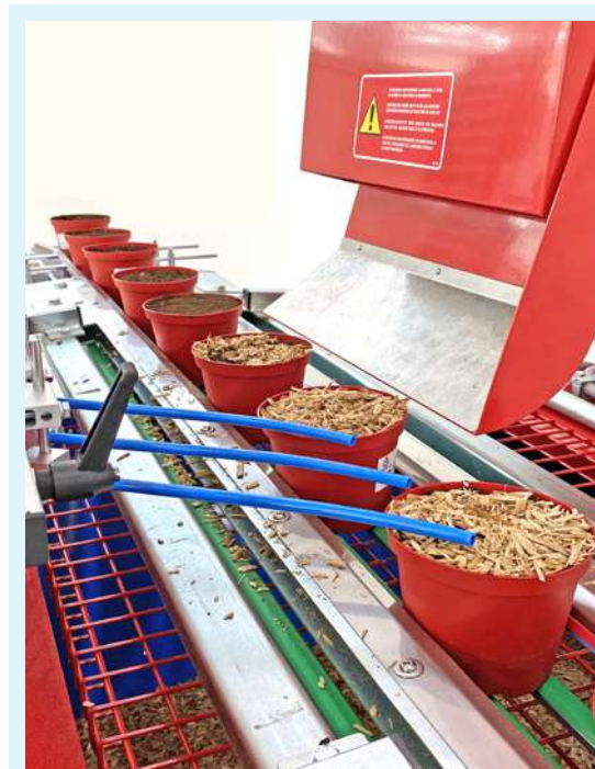
La posizione e l'altezza dei braccetti scolmatori sono regolabili manualmente : il materiale in eccesso rimosso viene automaticamente rimesso in circolo .
