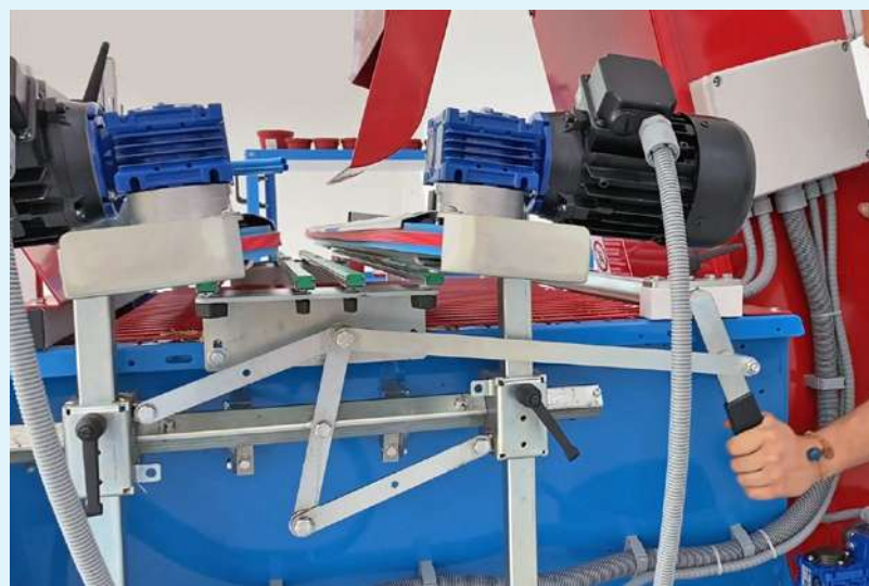
Ampiezza passaggio vasi regolabile velocemente con un'unica leva.
