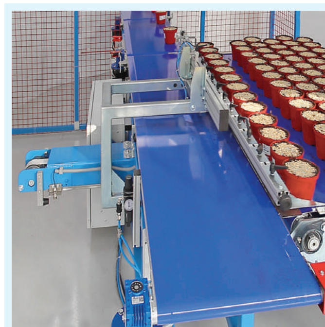
Spintore vasi con corsa 500 mm a controllo elettrico e gruppo sfalsamento file pneumatico (fino a 250 mm).
