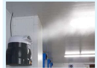
Humidificador funcionando dentro de la cámara.
