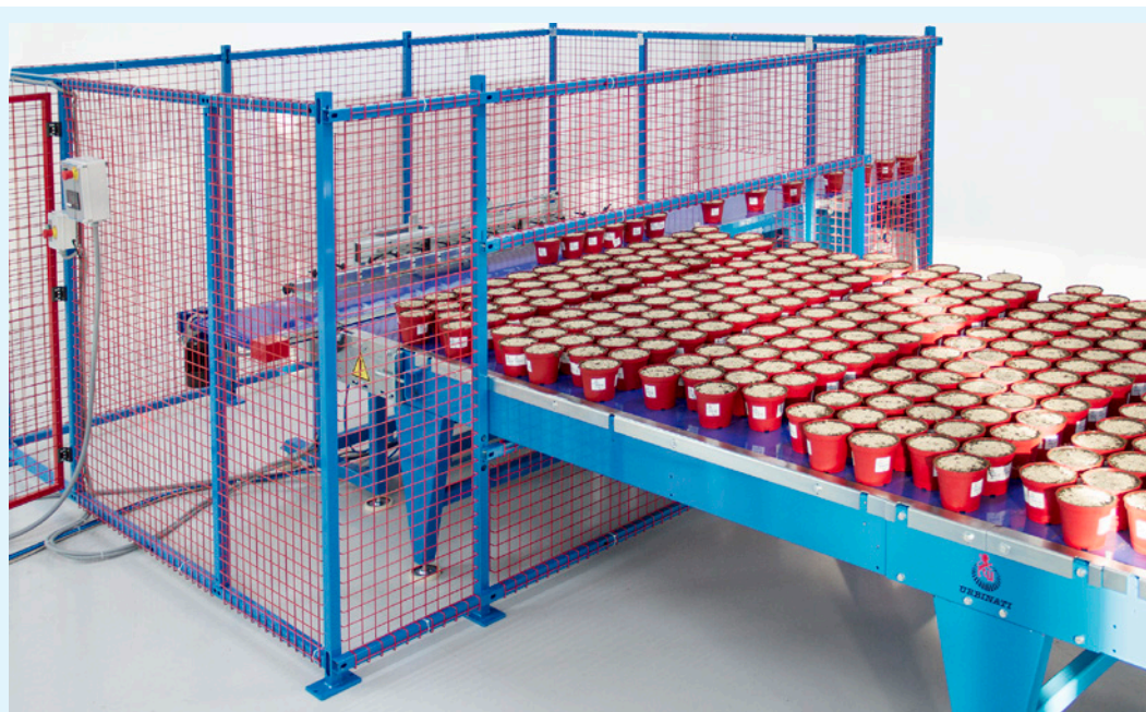
Les pots sur le convoyeur peuvent être positionnés en quinconce ou carrés.
