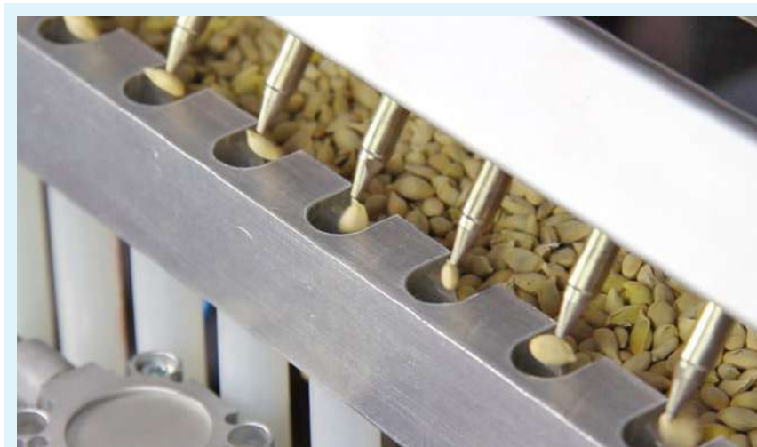
Las boquillas también pueden sembrar semillas de grandes dimensiones , como las de cítricos.
