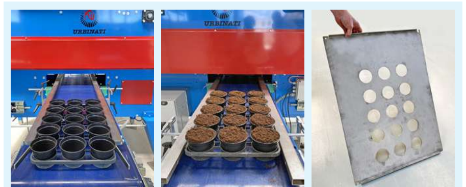
Contenedor portamacetas con macetas a la vista, en entrada y en salida de la llenadora ; sobre la derecha, la plantilla relativa de llenado a 15 orificios realizada a medida.
