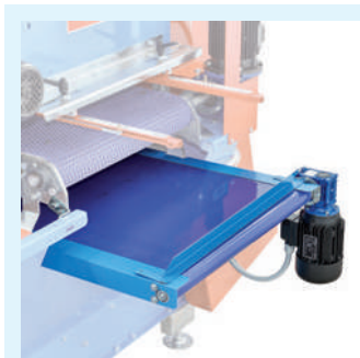
53 Cinta de recuperación del sustrato residual.
