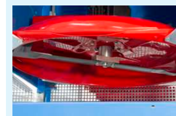
Segadora CIMA: detalle de cuchillas.
