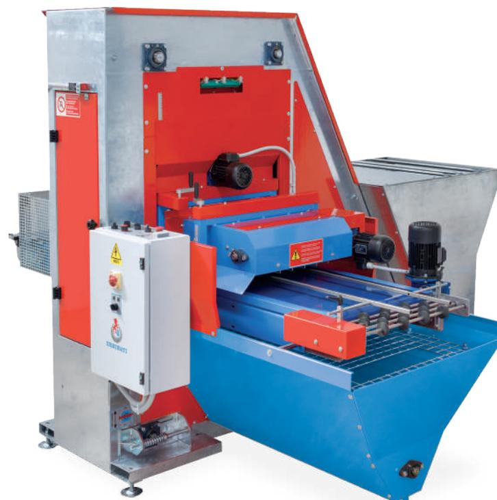
*RT12: version gauche avec tableau électrique sur le côté droit, avec compacteur de terreau et rouleau motorisé en sortie à 4 rangées.*
