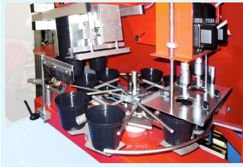
Versione a doppia testata , per vasi da 8 a 14 cm: produzione fino a 3500 vasi/ora.
