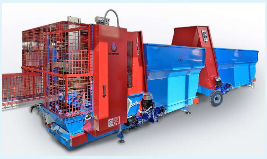
IA3500 con nastro uscita vasi centrale, in linea con TR2800 con funzione di riserva terriccio.
