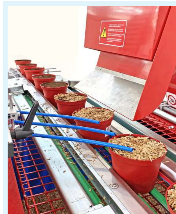
Invasatrice IA3500 a testata singola: è in grado di lavorare con vasi da 8 a 25 cm, di diverse forme e materiali.
