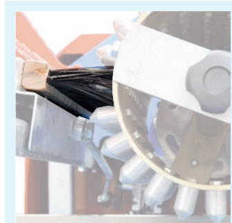
Spazzola oscillante per la pulizia del rullo impronta: particolarmente indicata in presenza di terricci umidi. 8
