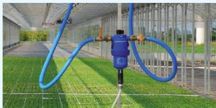
Dosatore proporzionale applicato direttamente sulla barra di irrigazione.
