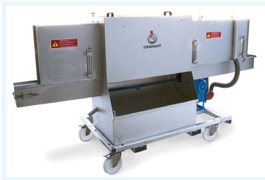
La fourniture d'un filtre à tiroir ouvert permet un nettoyage même pendant le cycle de travail, sans interruption .
