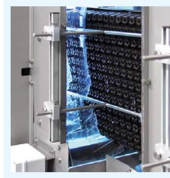
Unité de désinfection pour le traitement des plaques avec lampes rayons UV.
