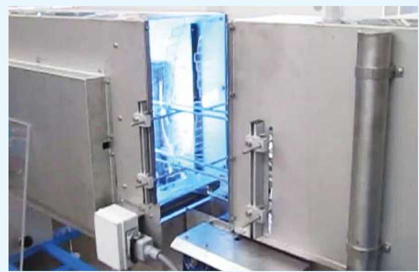
Unité de désinfection pour le traitement des plaques avec lampes rayons UV.
