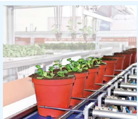
Positionnement des pots sur le convoyeur avec vérins (pots diamètre de 9 à 20 cm).
