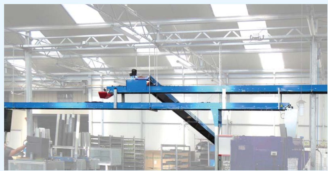
Cintas NTV suspendidas para transporte de sustrato : rendimiento máximo con mínimo estorbo en suelo.
