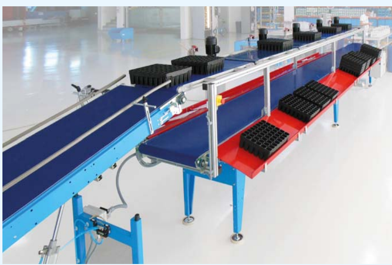
Cinta NTV neumáticamente inclinable : se puede alinear con el estante superior para la función de trasplante o con el inferior para el transporte.
