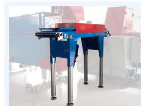
Cinta NTV con patas especiales y lados altos para el transporte del sustrato.
