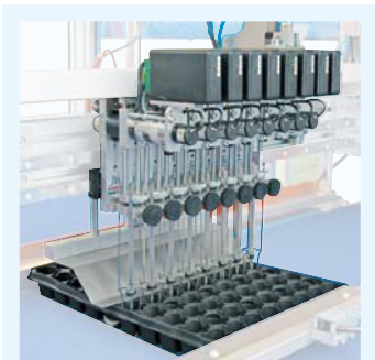
Blocco dall'alto nell'asse prelievo per seminare termoformate.
