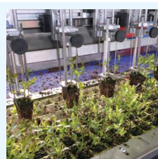
Le pinze con la stella aperta consentono il trapianto di varietà forestali .
