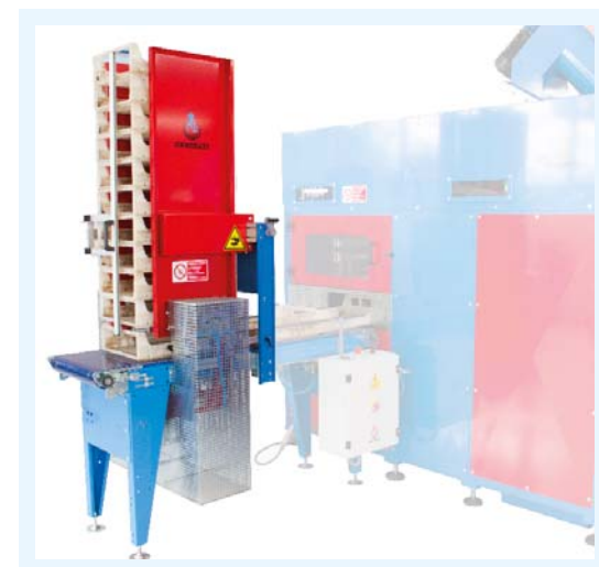
Distributore per seminiere o cassette posizionato all'ingresso del PRESSATORBA.
