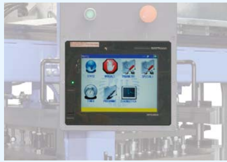
Monitor touch-screen a colori da 8,4" per il controllo della macchina.
