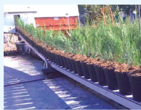
Convoyeurs NTA en ligne avec changement de niveau.
