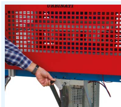
Profondità impronta regolabile con una comoda manovella.
