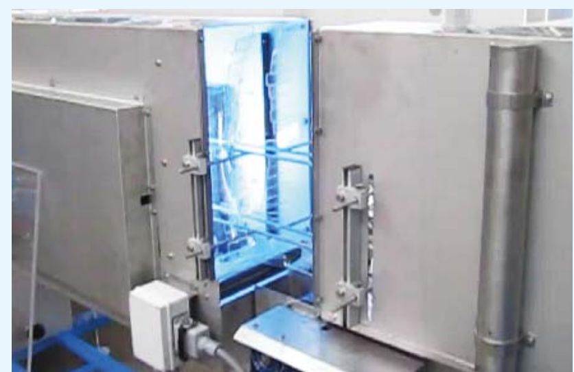
Tunnel per il trattamento delle seminiere con lampade a raggi UV.
