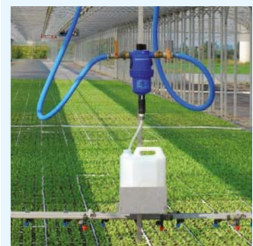
Dosatore proporzionale applicato direttamente sulla barra di irrigazione.
