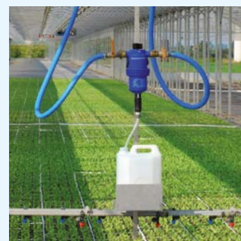
Dosatore proporzionale applicato direttamente sulla barra di irrigazione.
