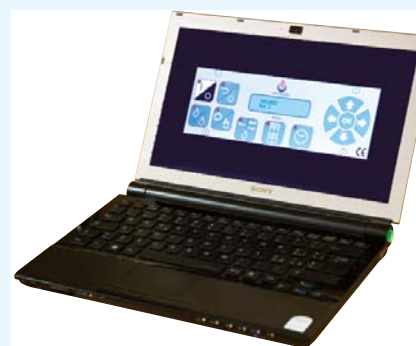
I quadri elettrici possono essere controllati da un PC tramite un collegamento RS 485.
