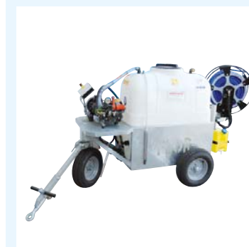
Pompa ad alta pressione carrellata per trattamenti fitosanitari con aspirazione del liquido residuo.
