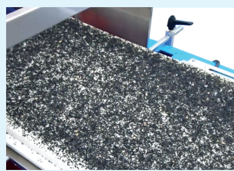
Siembra vibratoria de semillas medianas.
