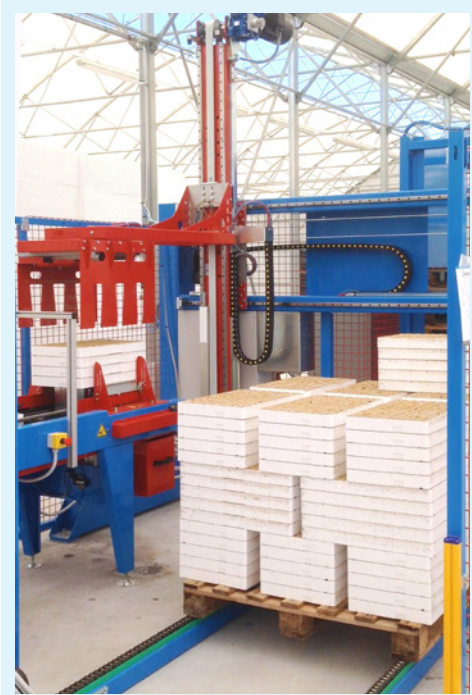
Phase de dépôt: plaques empilées sur la palette .
