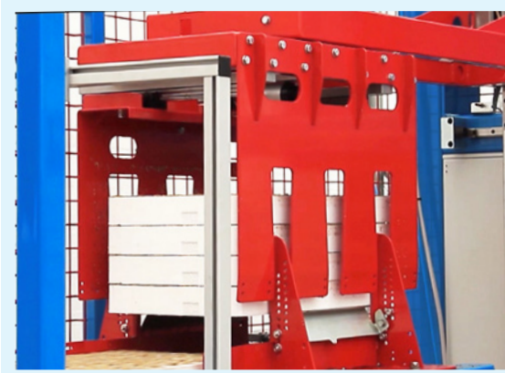
Palettiseur pour plaques : pince en phase de prélèvement .
