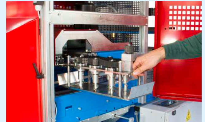
Las guías deslizables de soporte vuelven fácil y rápido el procedimiento de extracción de la placa .
