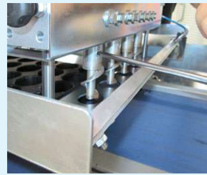
Taladros fácilmente intercambiables , para adaptar la máquina a las exigencias de producción.
