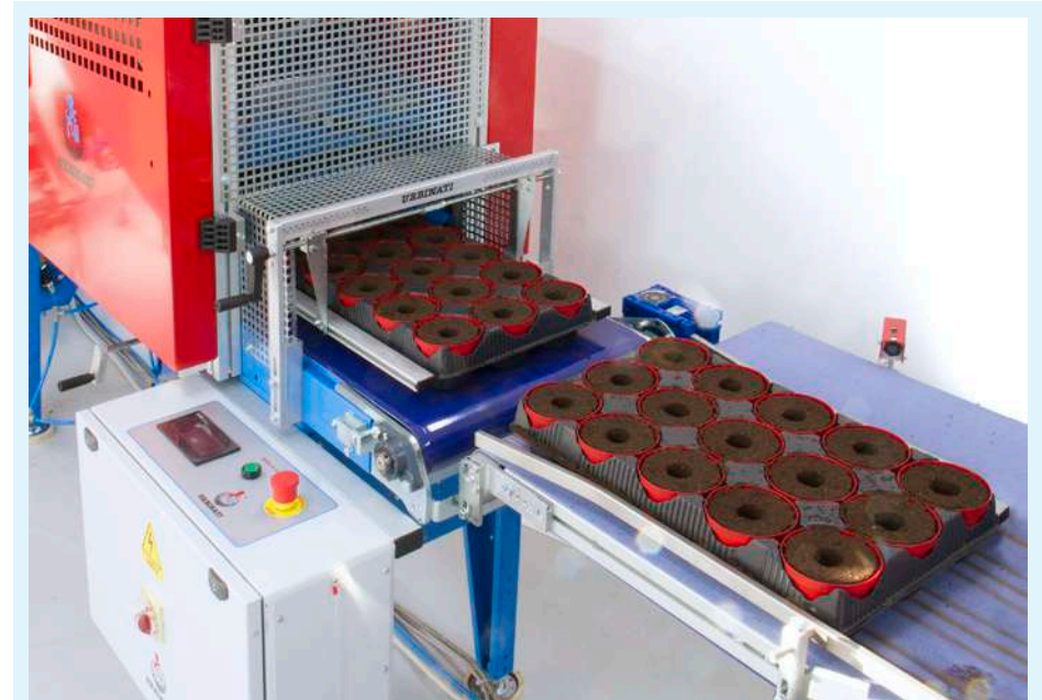
Pots sortant de la machine automatique pour le forage NIR. La machine est insérée dans une ligne de travail .
