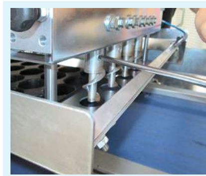
Foreurs facilement interchangeables , afin d'adapter la machine aux exigences de production
