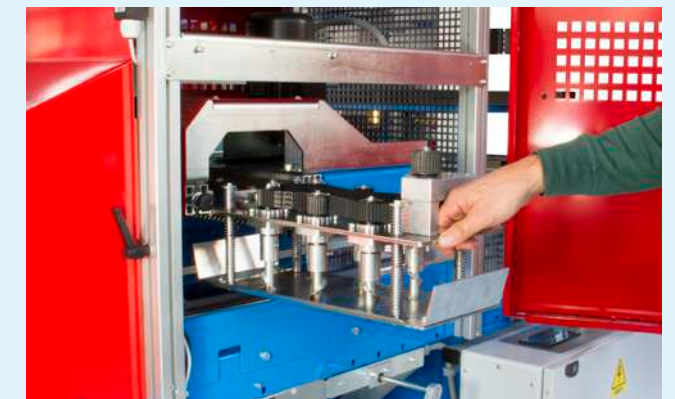
Le guide scorrevoli di supporto rendono facile e rapida la procedura di estrazione della piastra.
