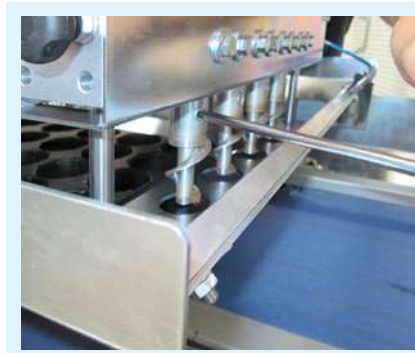
Trivelle facilmente intercambiabili , per adattare la macchina alle esigenze di produzione.
