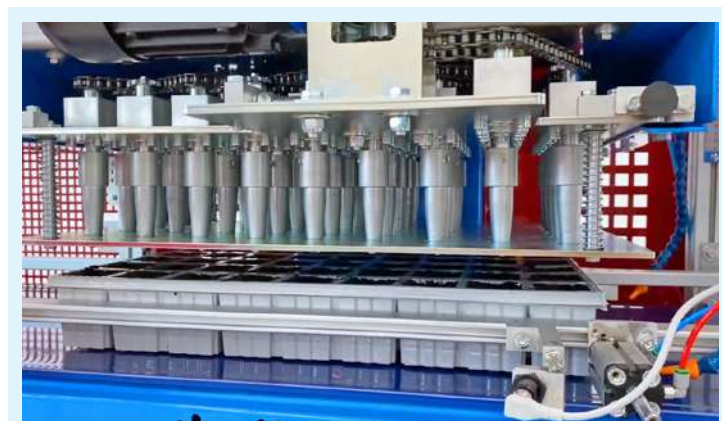
Plaque avec poinçons rotatifs (NPR) .
