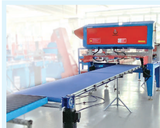
Nastri in uscita a due velocità , lato deposito: disponibili in diverse lunghezze L = 1300 / 2420 / 3000 / 4000 mm. Accessoriabili con leggii porta seminiere .
