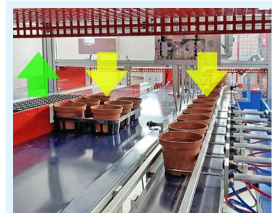
Con il terzo nastro supplementare per vasi singoli è possibile realizzare due aree di deposito .
