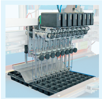
Blocco dall'alto nell'asse prelievo per seminare termofornate.
