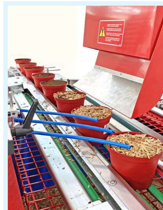
Invasatrice IA3500 a testata singola: è in grado di lavorare con vasi da 8 a 27 cm, di diverse forme e materiali.
