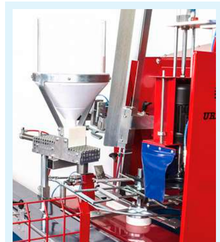
45 Dosatore di concime accessorio con serbatoio 15 l.
