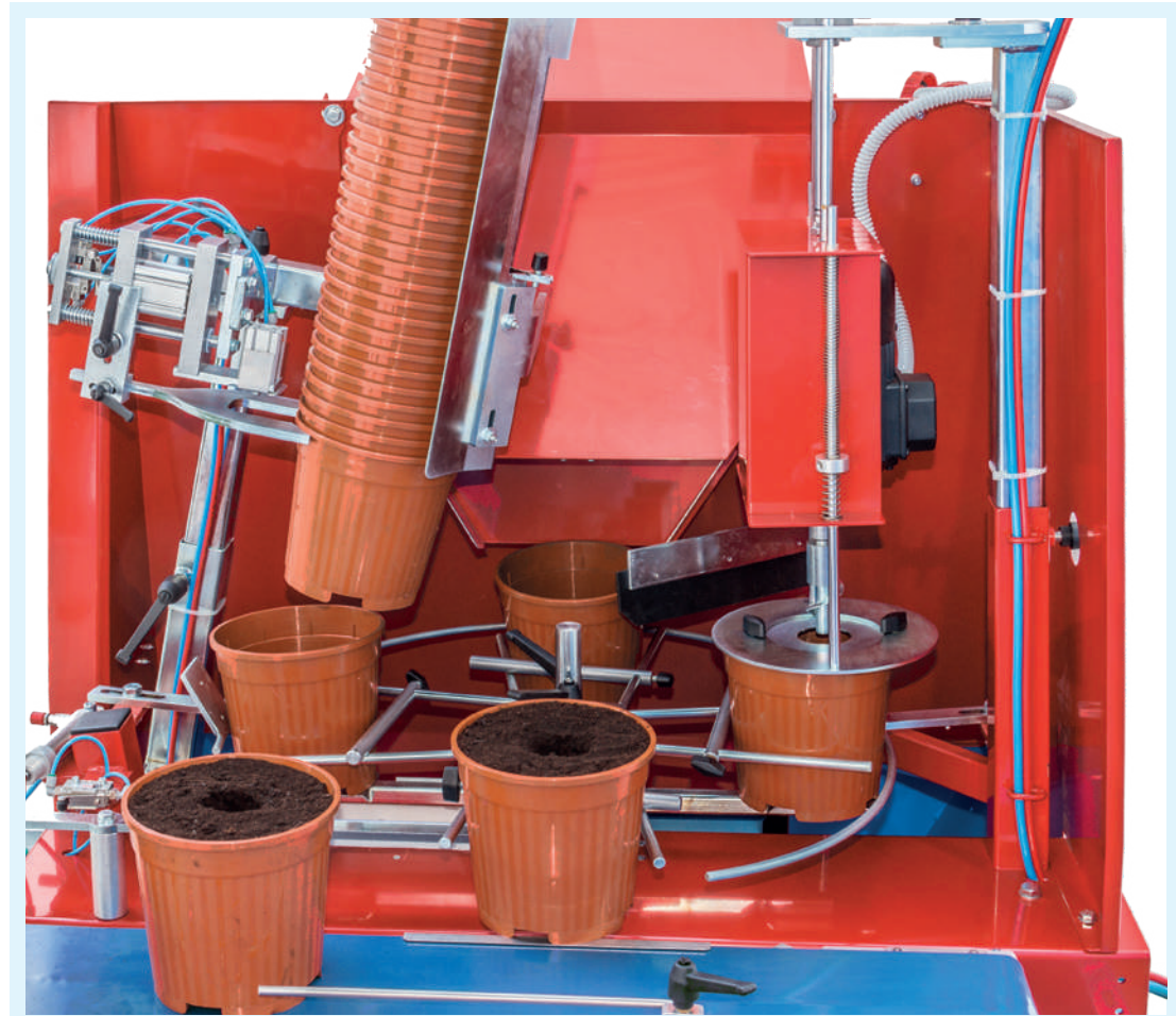
Versione ad una testata : produzione fino a 2400 vasi/ora .
