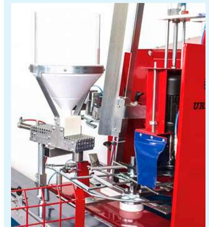
**45** **Dosificador de abono equipado con tanque de 15 l.**
