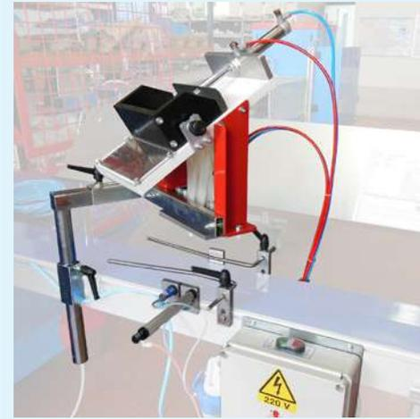
**40** **Sembradora mecánica para aromáticas**, completa con panel eléctrico, bloqueo para macetas y caída semillas apoyada por tubos o al voleo.
