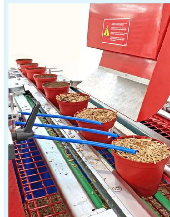
La **posición** y la altura de los **aparatos aliviadero** son **ajustables manualmente**: el material en exceso removido automáticamente se pone de nuevo en circulación.
