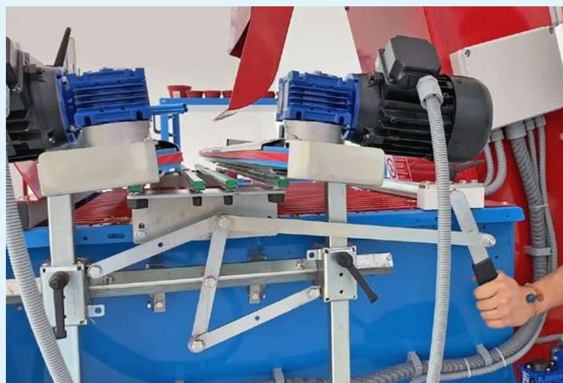
Ancho de **paso de los macetas** rápidamente ajustable con una sola manivella.
