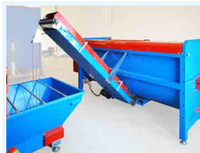
Cinta elevadora de suelo con sondas de nivel.
