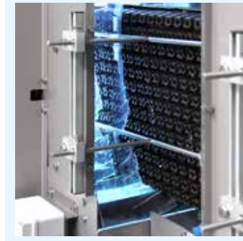
Tunnel per il trattamento dei contenitori con lampade a raggi UV.
