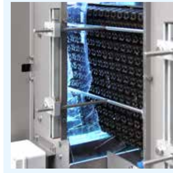
Unité de désinfection pour le traitement des plaques avec lampes rayons UV.
