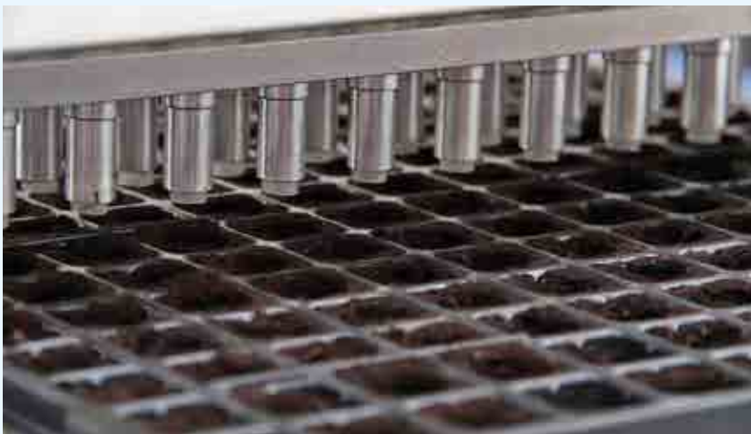
Ligne de semis KAPPA65C avec buses de semis à double rangée.
